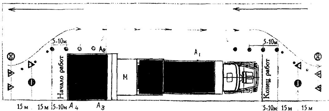
Рис.1 Схема расположения машин и рабочих
