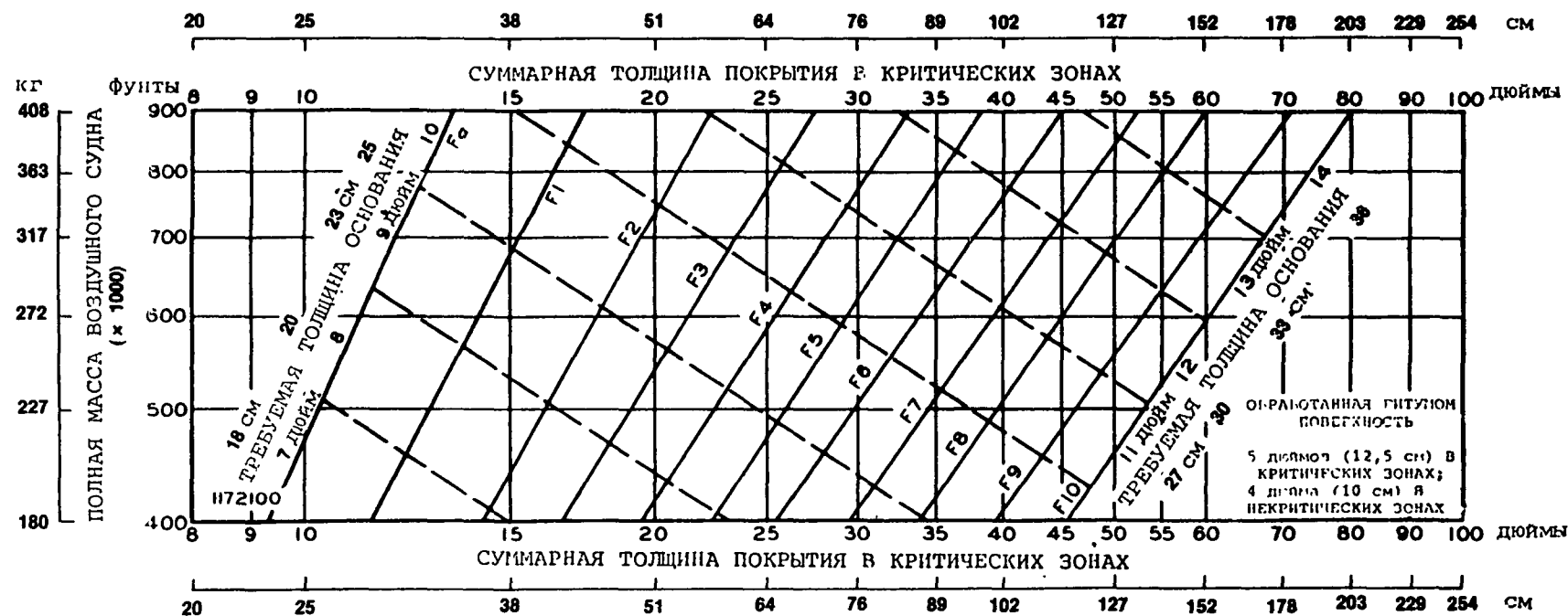
Рис. А4-11. Оценочные кривые для самолета В-747 для нежестких покрытий
