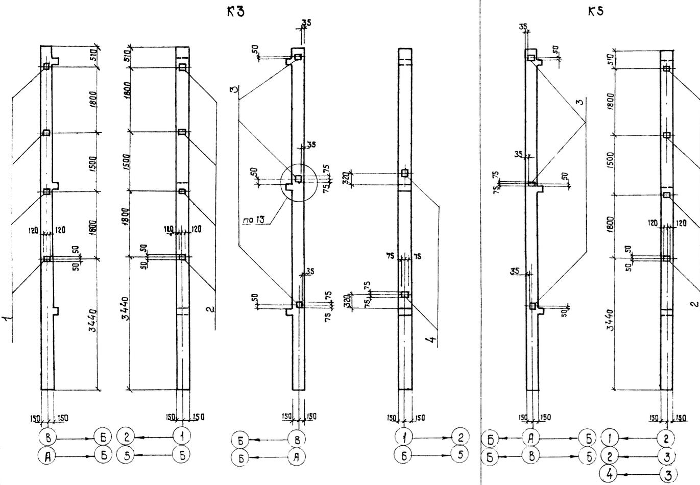
Спецификация дополнительных закладных деталей колонн
