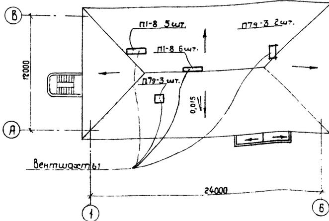
Вентшахты выполняются по размерам отверстий покрытий и накрываются плитами заспецифицированными на листе ксж-6. Ведомость перемычек ст. лист 9.
