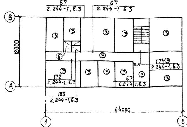
План полов на отм. 0.000 (здание с подвалом)
