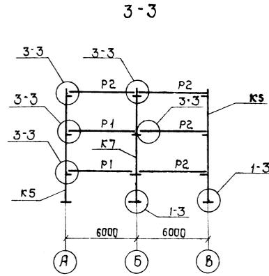
Схема расположения панелей Схемы расположения стоек покрытия на отм. 2.390
