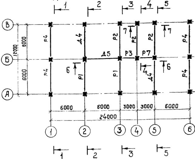
Схема расположения панелей перекрытия на отм. 0.000
