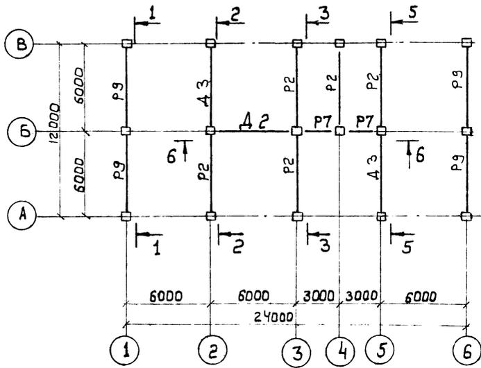
Схема расположения панелей покрытия
