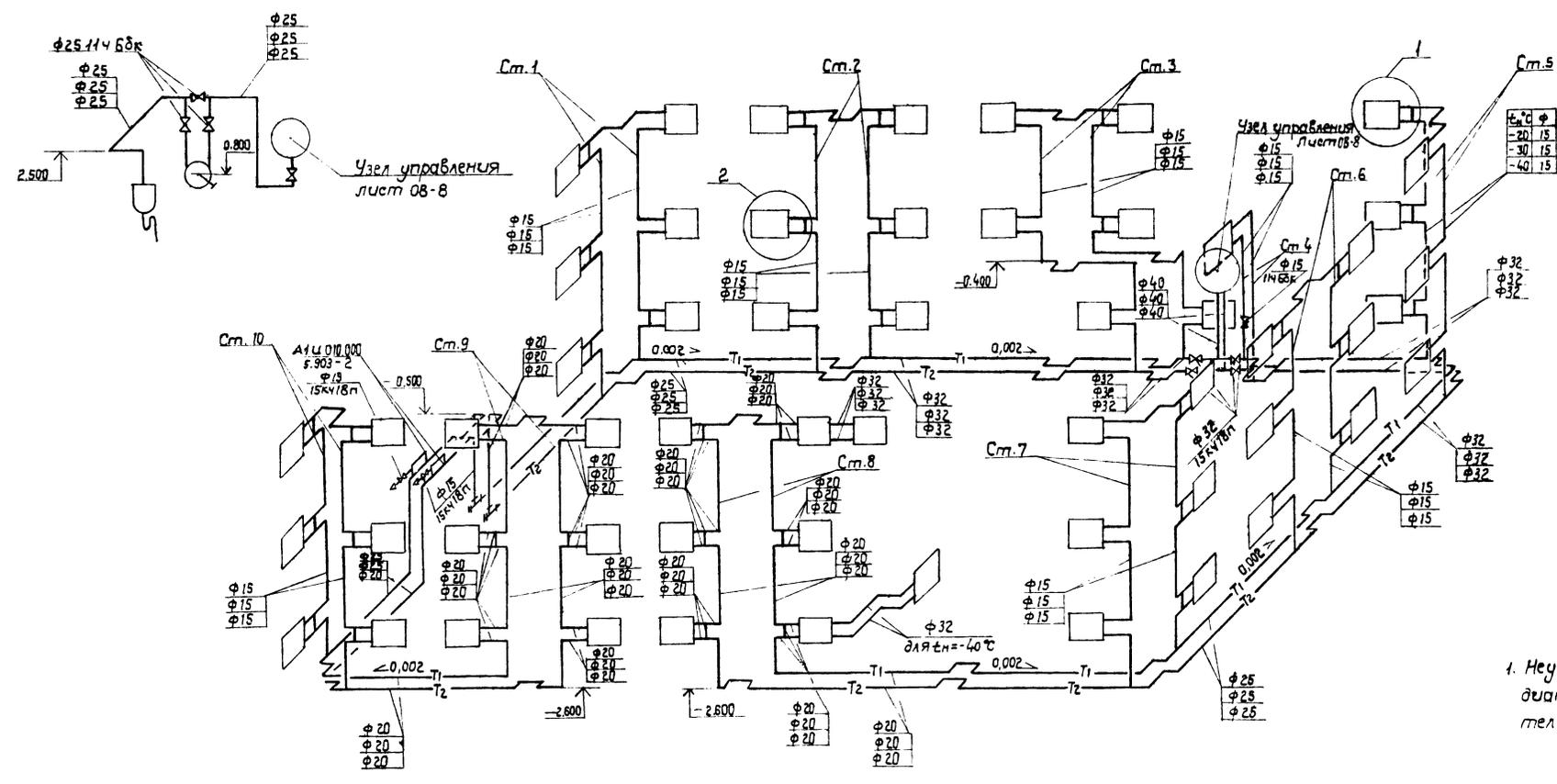
1. Неуказанные на чертеже диаметры подводок к нагревательным приборам принять 15 мм.
