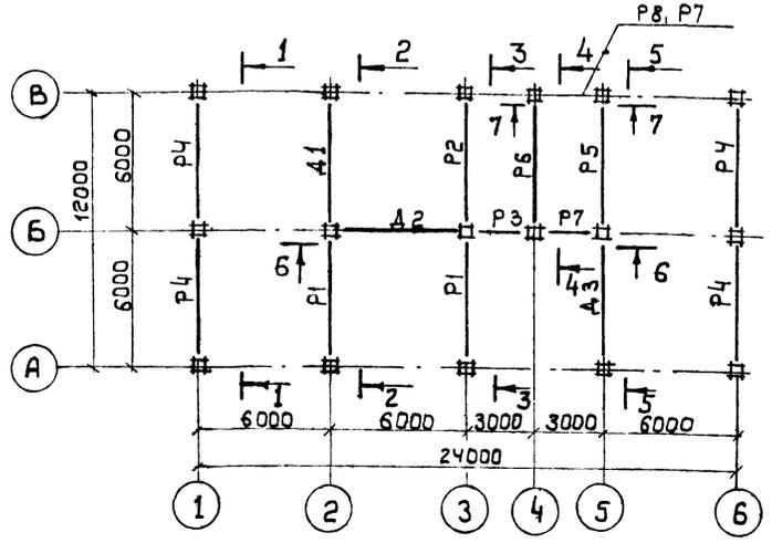
Схема расположения панелей перекрытия на отм. 3.300.
