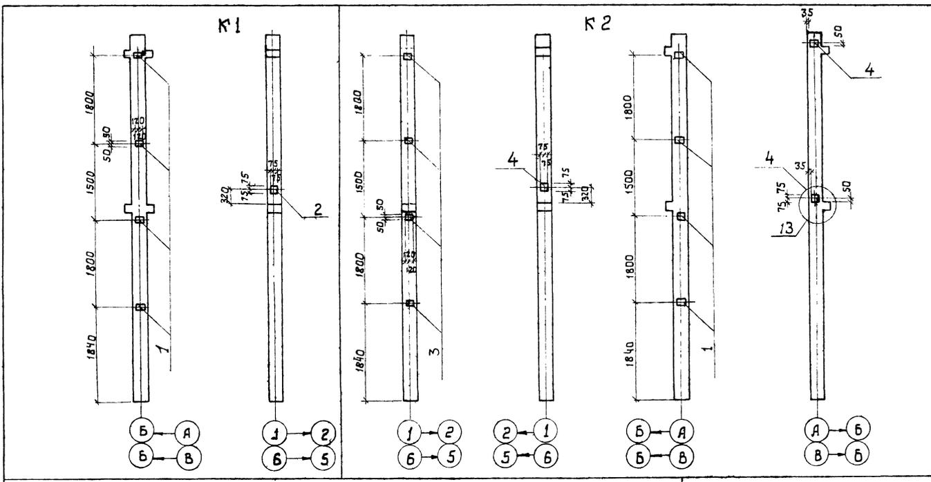
Спецификация дополнительных закладных изделий и колонн
