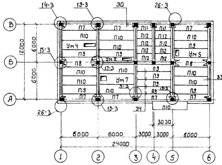
Спецификация элементов к схемам расположения ригелей покрытия, панелей покрытия и диафрагм жесткости
