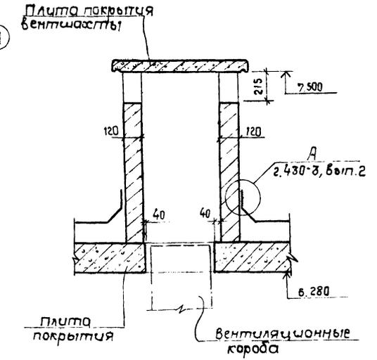
Вентшахты выполняются по размерам отверстий в покрытии и накрываются плитами заспецифицированными на листе које-б.
