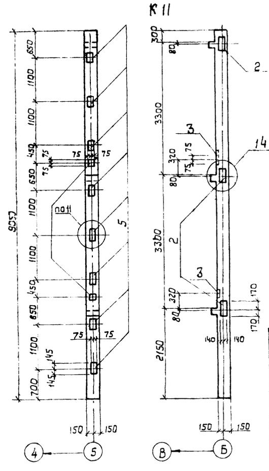
Спецификация дополнительных закладных деталей
