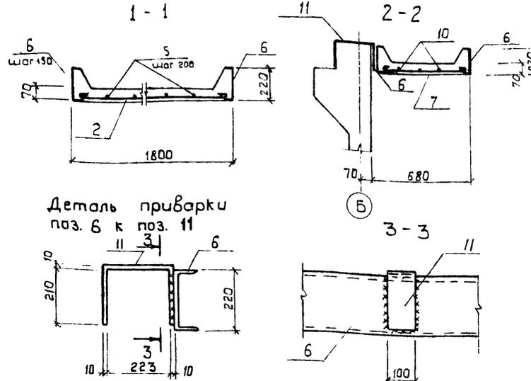
Деталь приварки поз. 6 к поз. 11
