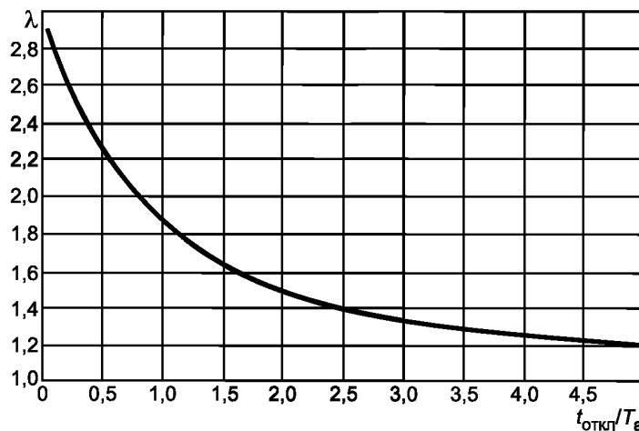
Рисунок В.1 — Зависимость коэффициента \lambda от t_{\text{откл}}/T_a
