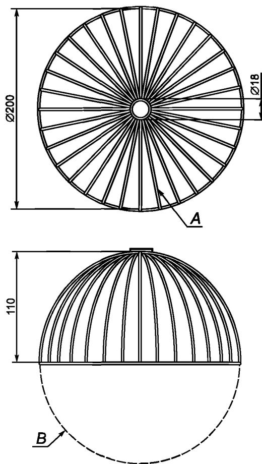
А — каркас, состоящий из 32 равномерно расположенных проволок диаметром  $(1,5 \pm 0,5)$  мм;
