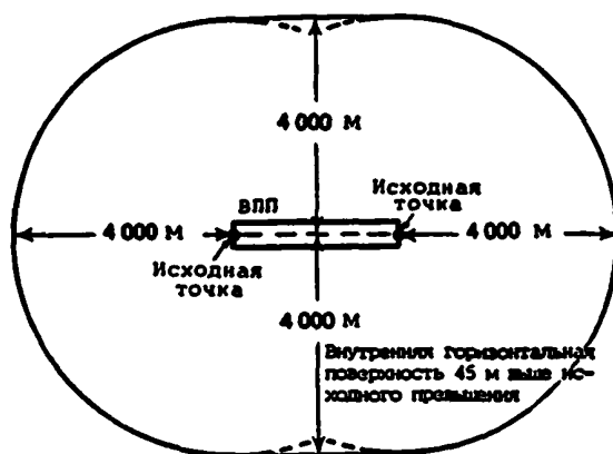
Рис. 1-1. Внутренняя горизонтальная поверхность для одной ВПП (кодовый номер ВПП - 4)
