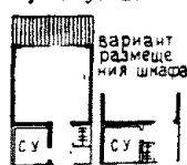
схема (встроенный шкаф в шлюзе у междокомнатной перегородки и у санузла)
