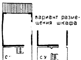
схема 2 (встроенный шкаф в шлюзе смежно с санузлом)
