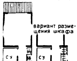
схема 1 (встроенный шкаф в шлюзе у межкомнатной перегородки)
