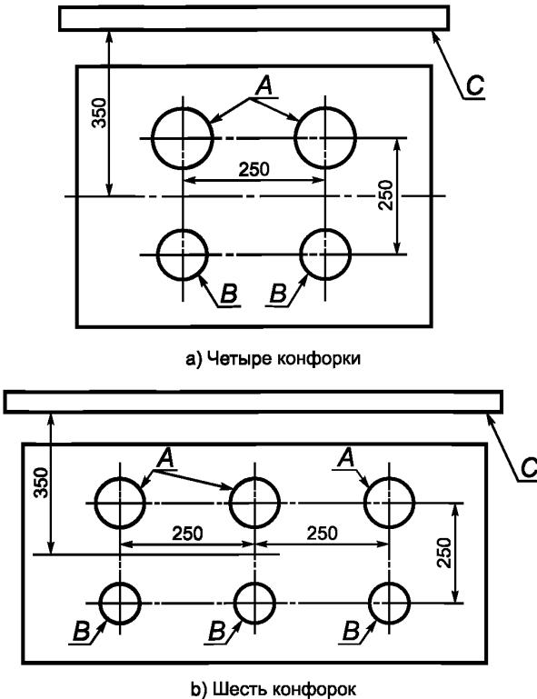
А — электрическая конфорка на 2 кВт; В — электрическая конфорка на 1,5 кВт;
