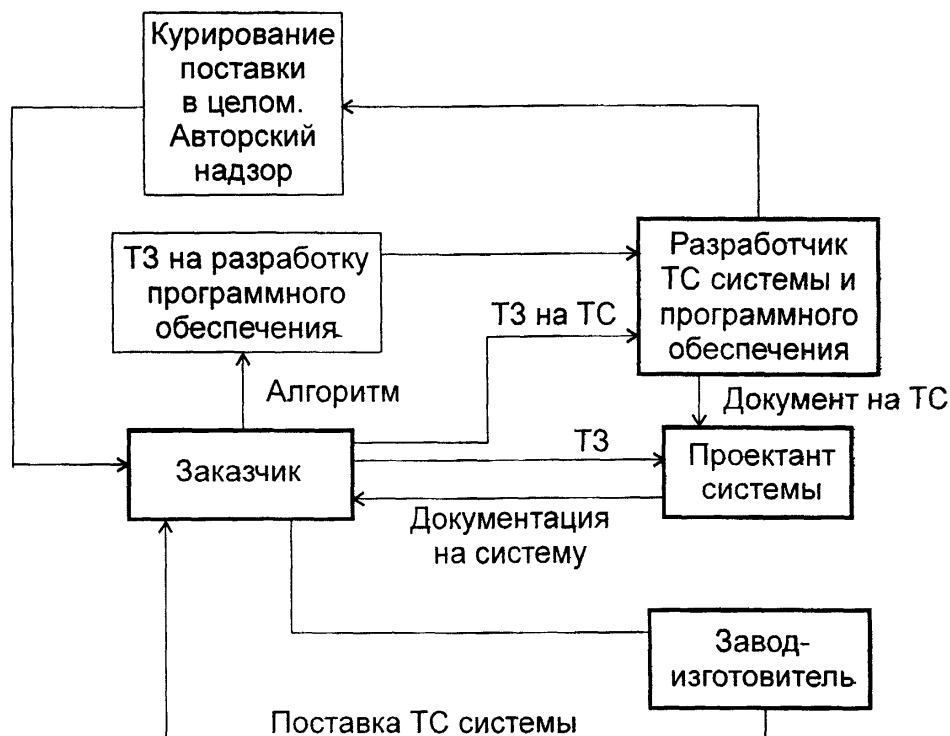
Рис.7. Одна из возможных схем взаимодействия Заказчика, разработчика комплекса ТС системы, проектанта автоматизированной системы и завода-изготовителя в части разработки программного обеспечения и поставки ТС системы
