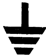
Рис. 13. Опознавательный знак заземлителя
