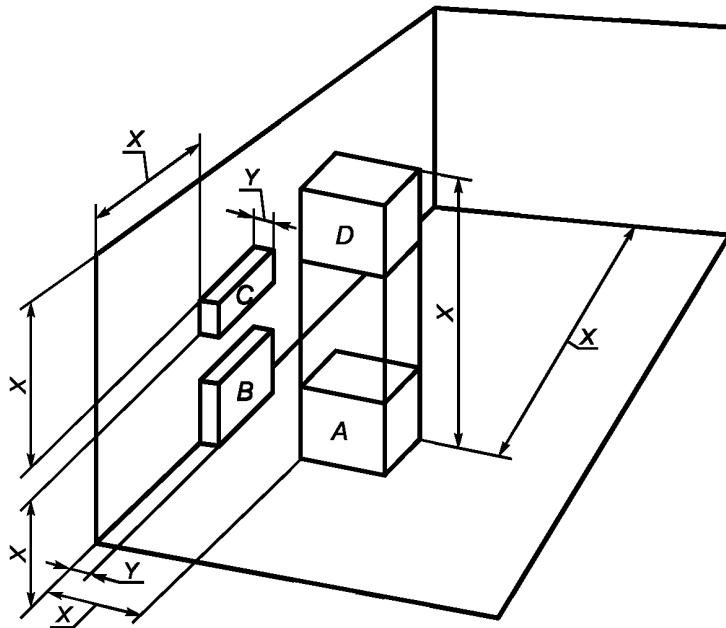
А — оборудование вдали от стены; В — оборудование, монтируемое вблизи пола или потолка и на стене или в стене; С — оборудование, монтируемое на стене или в стене; D — оборудование, подвешенное к потолку или закрепленное на нем или вмонтированное в потолок; X — минимальное расстояние от соседних поверхностей помещения, равное 1,5 м, если иное не установлено изготовителем; Y — рекомендованное изготовителем минимальное выступание оборудования в помещение
