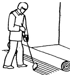
Рисунок 9 – Разравнивание клея гребенкой
