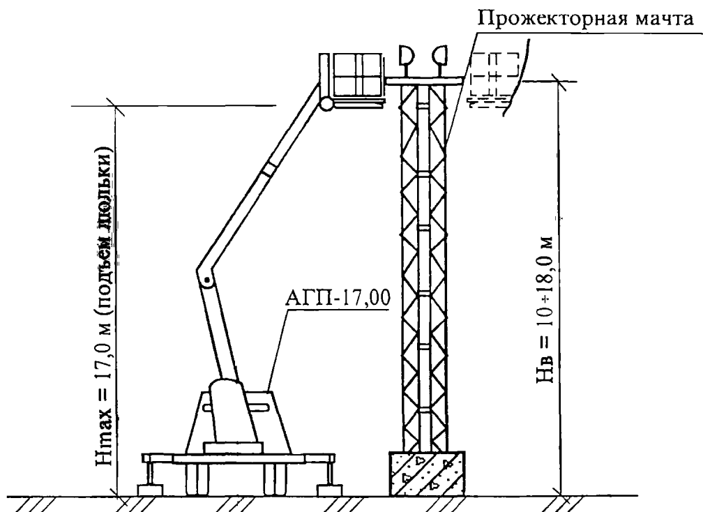
Рисунок 6 – Схема выполнения работ по обслуживанию опор освещения с использованием автомобильного подъемника АГП-17.00
