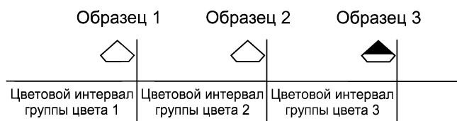
Рисунок 1 — Схема расположения образцов цвета бриллиантов на классификационной шкале цвета
