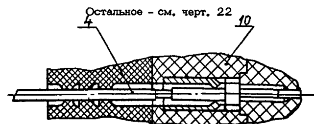
Исполнение 2 Заделка кабеля в контакт соединителя СНЦ, СНО, ОНЦ
