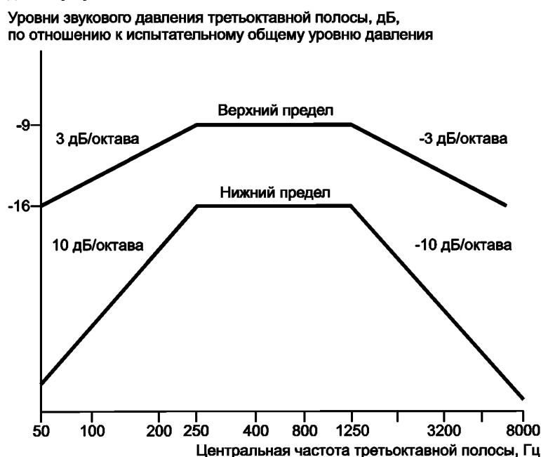
Рисунок 1 — Спектр третьоктавной частоты для авиационной техники
