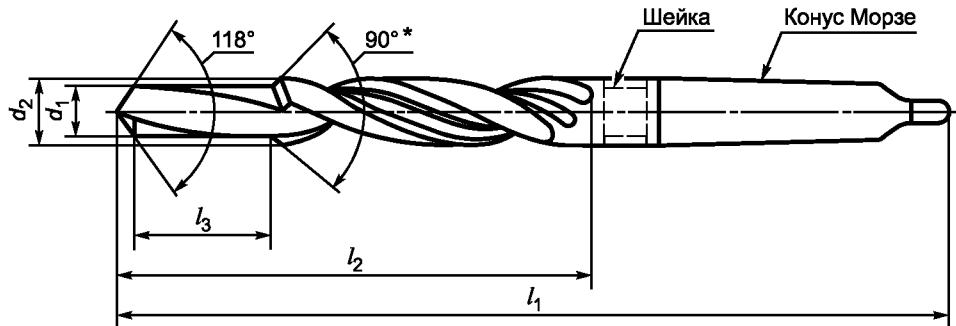
\* Допускается изготовление сверла с углом 120°.
