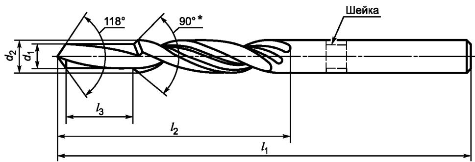
\* Допускается изготовление сверла с углом 120°.
