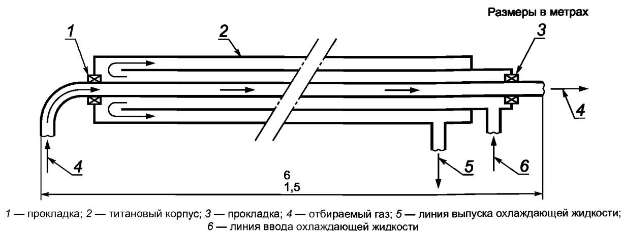
Рисунок В.8 — Пример охлаждаемого зонда
