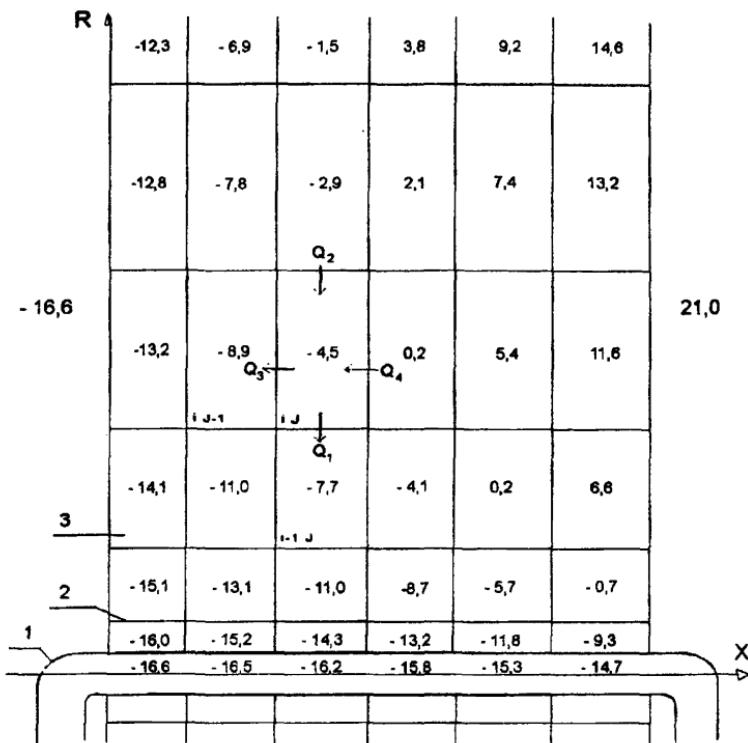
Рис. 1. Схематическое изображение сечения трубопровода и стены плоскостью. 1 - трубопровод, 2 - футляр, 3 - стена; стрелками обозначены направления тепловых потоков  $Q$ ; числами показаны значения температуры,  $^{\circ}\text{C}$ .
