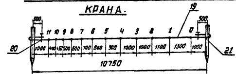
СХЕМА 10 а РАЗМЕТКА ШНУРА ДЛЯ ПЕРЕМЕЩЕНИЯ КРАНА.
