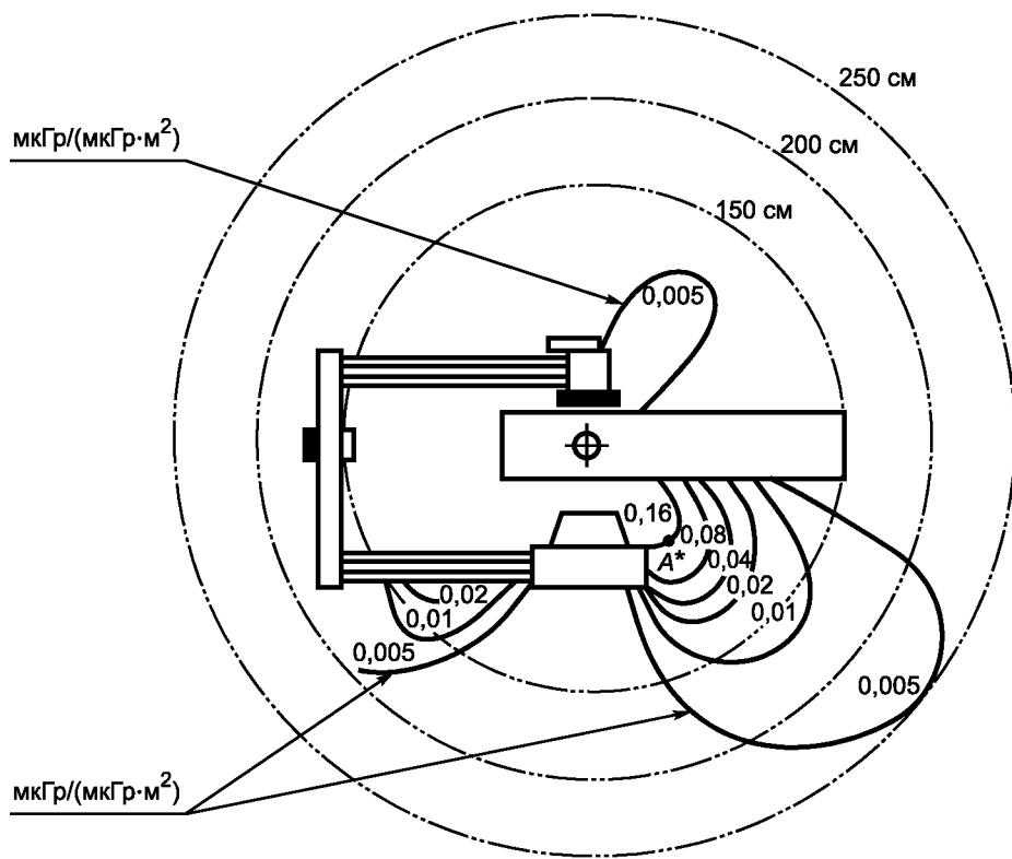
\* Пример определения дозы неиспользуемого излучения в месте расположения персонала (точка А): за время проведения исследований встроенный в аппарат измеритель ПРОИЗВЕДЕНИЯ ДОЗА × ПЛОЩАДЬ показал суммарное значение, например 100 мкГр · м<sup>2</sup>. Тогда значение суммарной дозы неиспользуемого излучения в точке А составит 16 мкГр.
