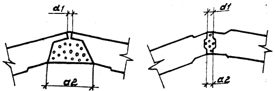
Деталь клиновидного стыка Деталь шлоночного стыка.
