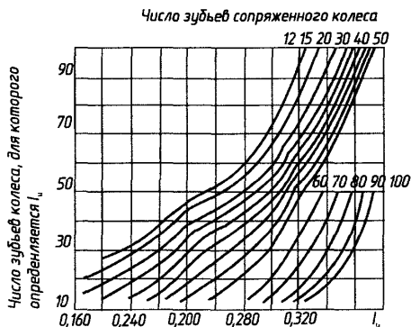
Рис. 1. Определение коэффициента I_n при расчете на изгиб ( \alpha_{cp} = 20^\circ ; \beta_{cp} = 35^\circ )
