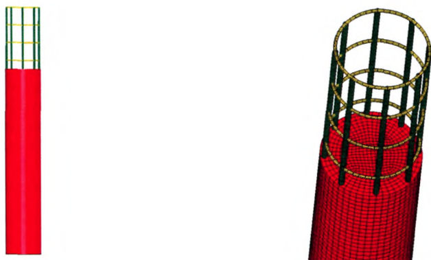
Рисунок В.1 - Геометрические и сеточные модели колонны и арматуры (часть колонны не показана)
