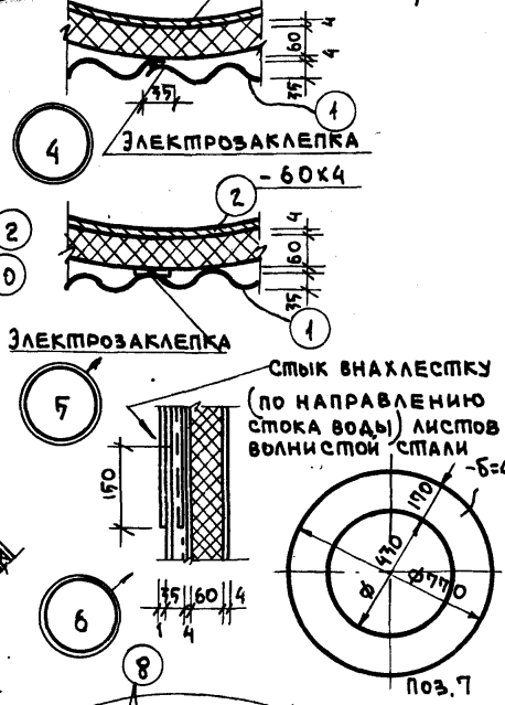
Деталь утепления пружа Минераловатные мягкие плиты марки ПМ" 1000x1000, δ=60 мм
