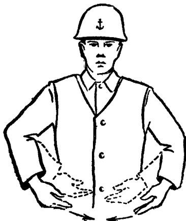
Рис. 10. Обе руки полусогнуты в локтях, опущены вниз, ладонями внутрь. Обеими руками производить движения внутрь.
