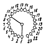
Диаграмма работы контактов переключателя «П» типа 23П2Н2
