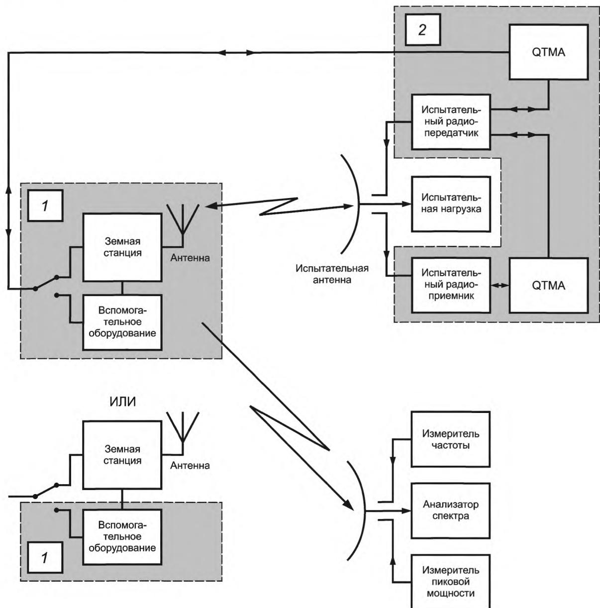
1 — испытуемое оборудование; 2 — испытательная система;
