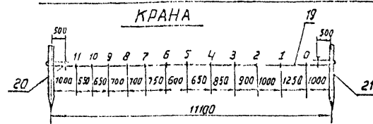
СХЕМА 10 а РАЗМЕТКА ШНУРА ДЛЯ ПЕРЕМЕЩЕНИЯ КРАНА
