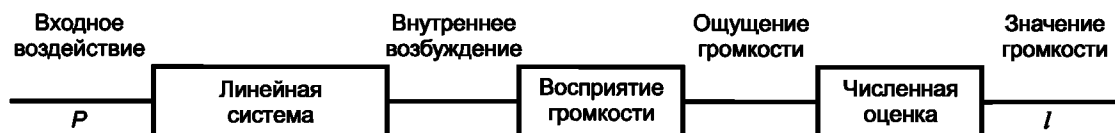
Рисунок С.1 — Блок-схема модели процесса оценки громкости
