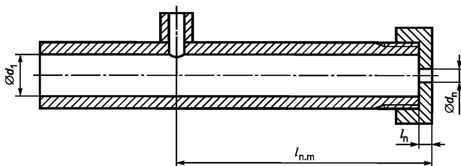
$d_n$  — диаметр отверстия сопла, равный  $(4 \pm 0,1)$  мм;  $l_n$  — длина отверстия сопла, равная  $(4 \pm 0,1)$  мм;  $d_1$  — внутренний диаметр трубы, равный  $(12,5 \pm 1)$  мм;  $l_{n,m}$  — расстояние между отверстием сопла и манометром, равное  $(80 \pm 1)$  мм
