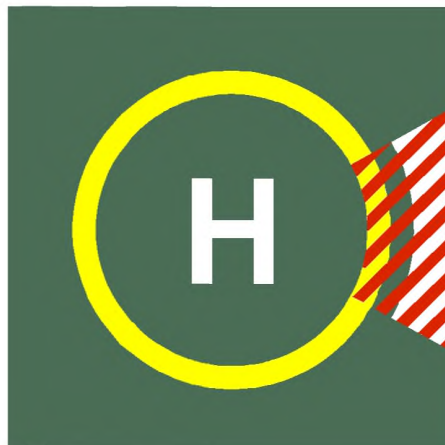
Рис. 5-7. Маркировка запрещенного для посадки сектора вертопалубы
