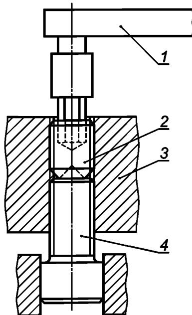
1 — гаечный ключ с ограничением по крутящему моменту; 2 — испытуемый винт; 3 — испытательный блок твердостью не менее 50 HRC с допуском 5Н (по ИСО 965-3) для внутренней резьбы; 4 — опорный винт твердостью от 450 до 570 HV
