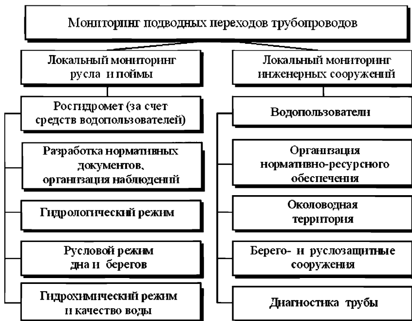
Рисунок 14.1 — Структура мониторинга подводных переходов трубопроводов
