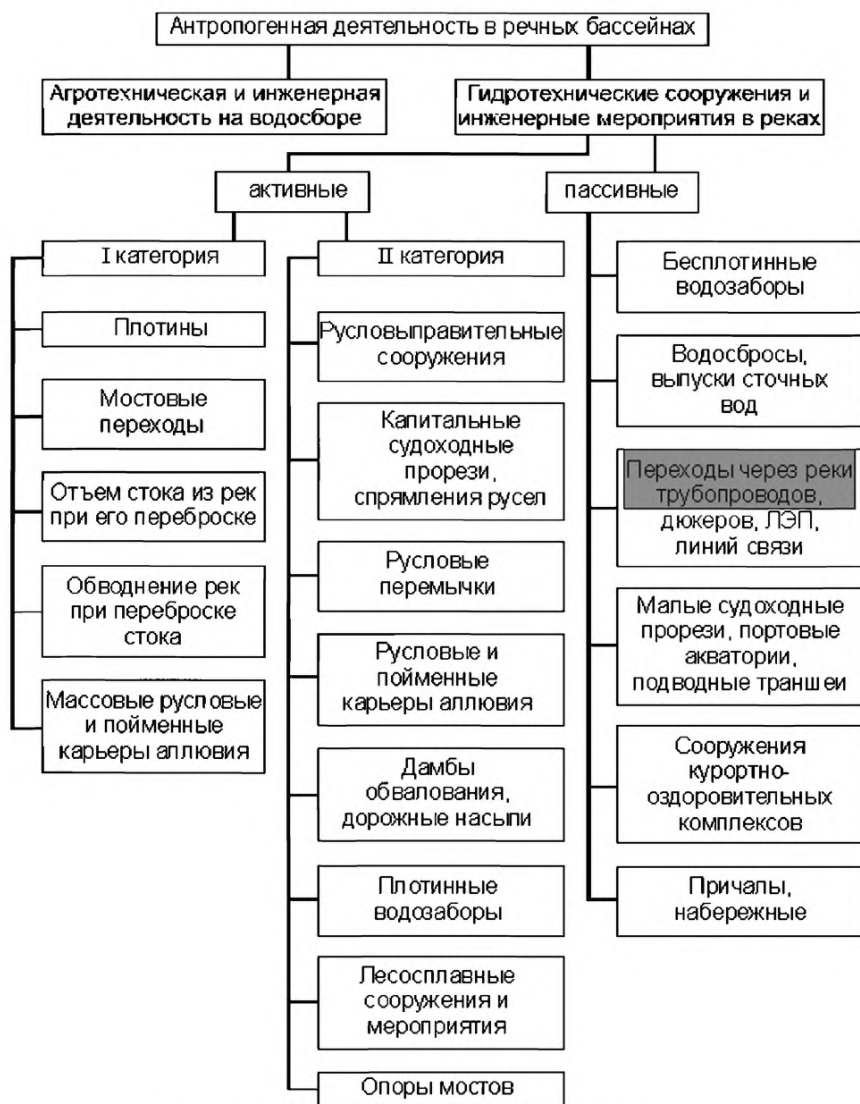
Рисунок А.1 — Классификация речных инженерных сооружений и мероприятий по характеру взаимодействия с русловым процессом
