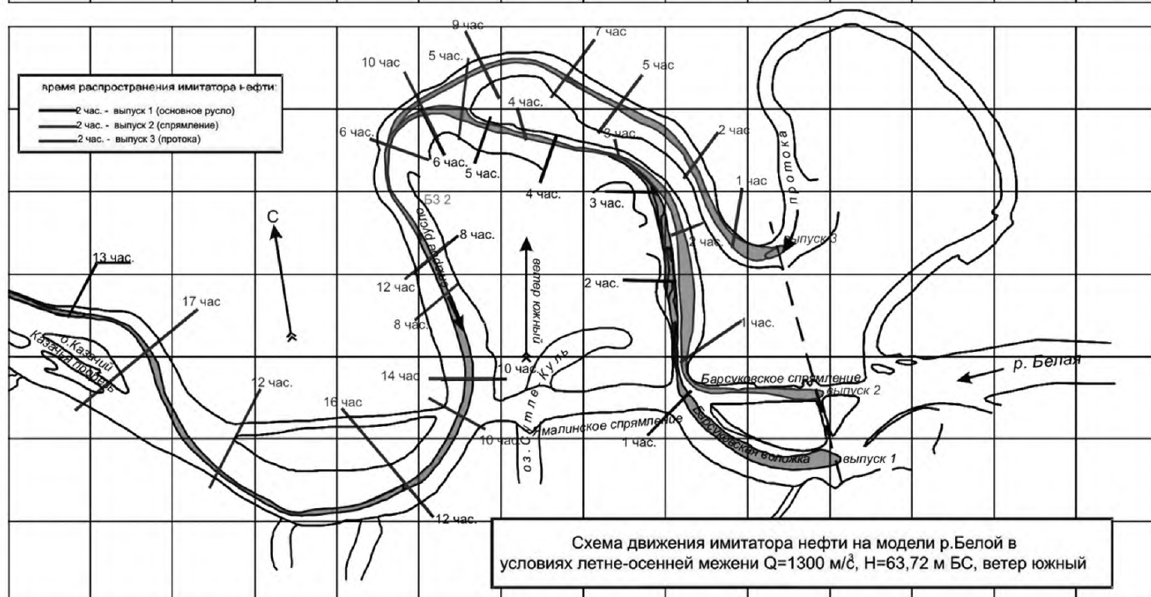
Рисунок Е.3 — Схема распространения имитатора нефти на модели р. Белой в разных погодных условиях
