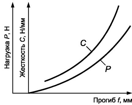
Жесткость пружины  $C$ , Н/мм, определяют, как минимум, в пяти точках зависимости нагрузки  $P$  от прогиба  $f$  как производную  $dP/df$ .
