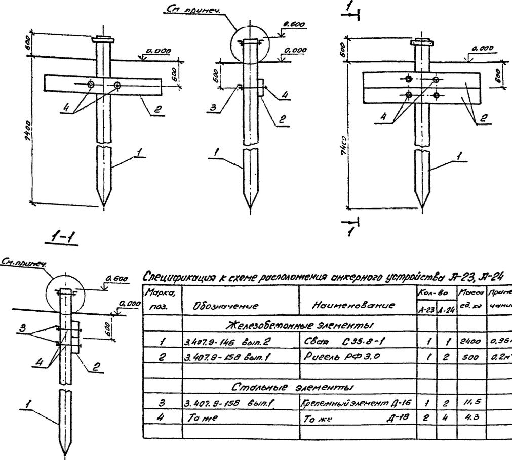
Спецификация к схеме расположения анкерного устройства А-23, А-24
