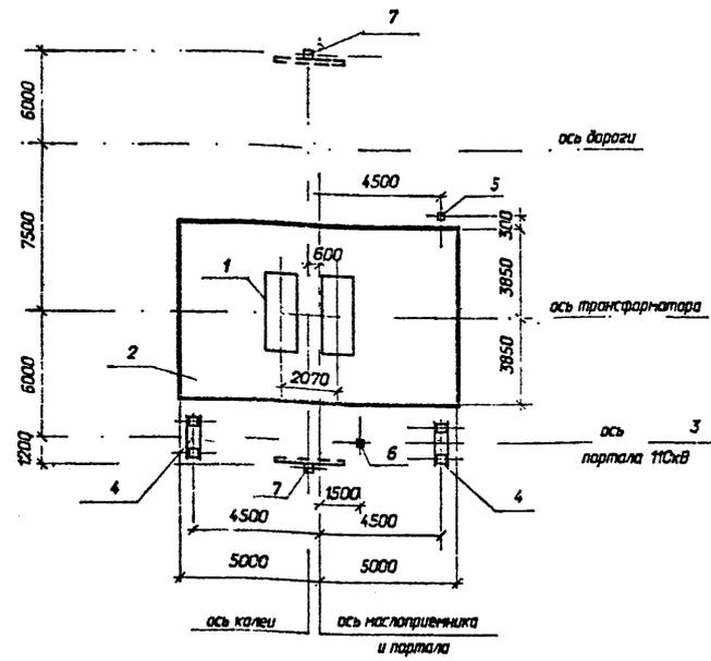
Спецификация к схеме расположения строительных конструкций
