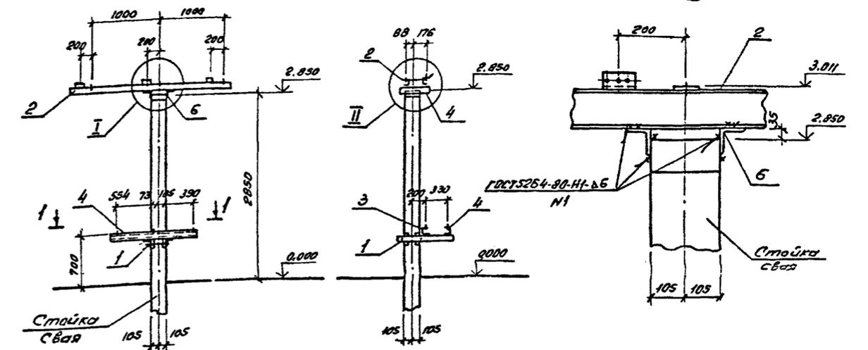
Спецификация к схеме расположения стальных элементов опоры 0-110-6
