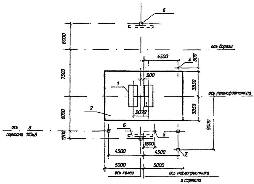
На чертеже показано расположение одностаечной опоры 35кВ при выводе ошиновки СН влево, при выводе ошиновки СН вправо одностаечную опору 35кВ расположить зеркально.
