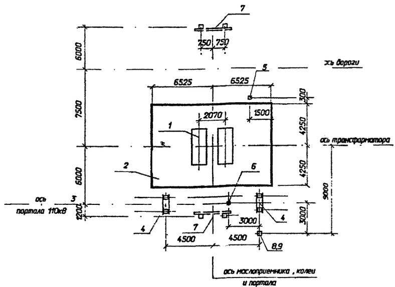
На чертеже показано расположение одноствоечной опоры 35кВ при выводе ошиновки СН влево, при выводе ошиновки СН вправо одноствоечную опору 35кВ расположить зеркально.
