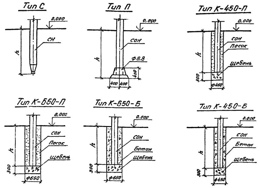
1. Предельное отклонение стоек допускается: по вертикали ±15мм, по горизонтали ±20мм или их наклон над поверхностью земли не более 10мм на 1м. длины, разворот стоек на угол ±5°.
