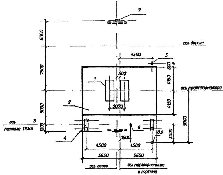
На чертеже показано расположение одноствоечной опоры 35кВ при выводе ошиновки СН влево, при выводе ошиновки СН вправо одноствоечную опору 35кВ расположить зеркально.
