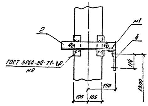
Спецификация стальных элементов на опоры 0-110-3, 0-110-4
