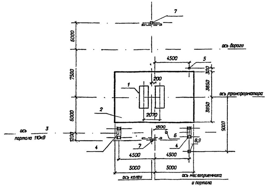
На чертеже показано расположение одностаечной опоры 35кВ при выводе ошиновки СН влево, при выводе ошиновки СН вправо одностаечную опору 35кВ расположить зеркально.
