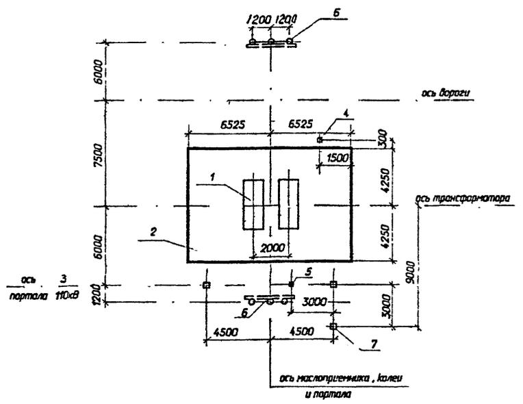
На чертеже показана расстановка одноствоечной опоры 35кВ при выводе ошиновки СН влево, при выводе ошиновки СН вправо одноствоечную опору 35кВ расположить зеркально.
