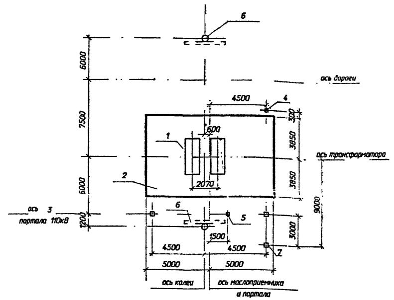
На чертеже показано расположение одностаечной опоры 35кВ при выводе ошиновки СН влево, при выводе ошиновки СН вправо одностаечную опору 35кВ расположить зеркально.
