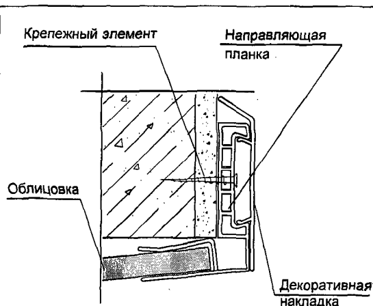
Схема крепления листов облицовки в профилях откосной системы
