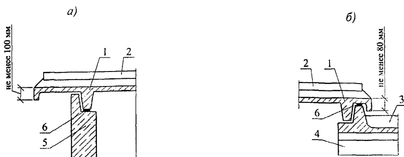
Рисунок Т.2 – Конструкции стыков кровельных панелей
