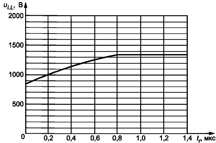
Рисунок 7 — Зависимость допустимой амплитуды импульса напряжения на зажимах двигателя u_{LL} от времени нарастания импульса t_r
