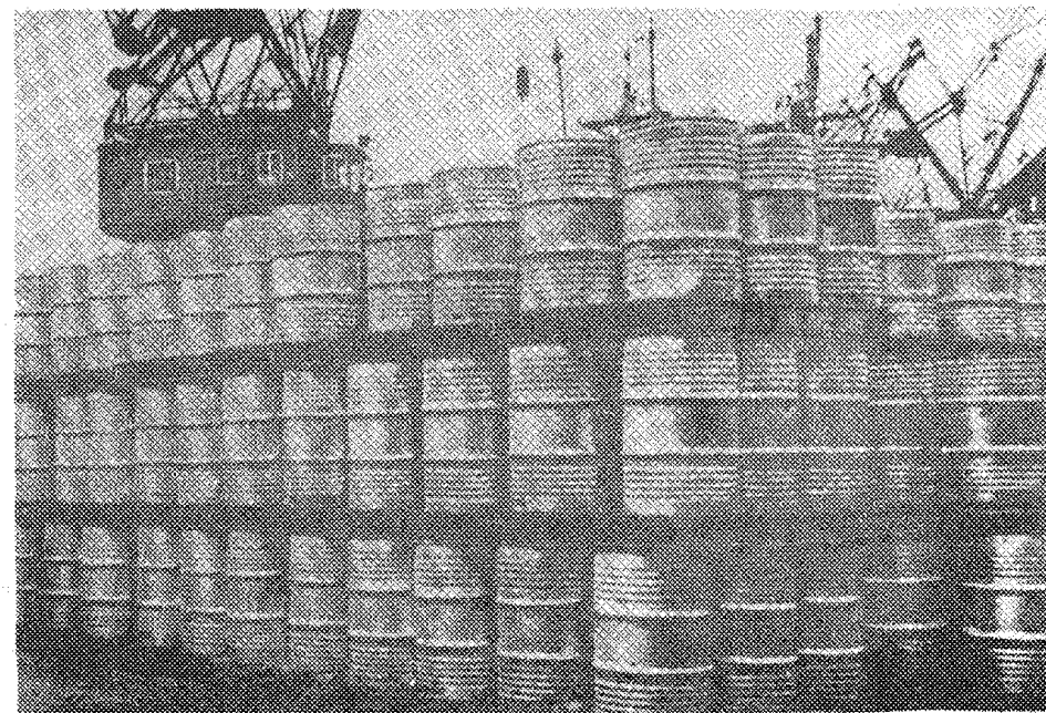
Рис.301.4. Складирование пакетов металлических бочек на плоских поддонах. Порт Рига.
