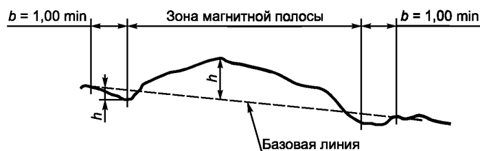
Рисунок 9 — Выпуклый профиль полосы
