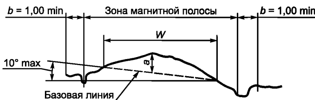
Рисунок 7 — Выпуклый профиль полосы
