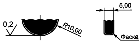
Рисунок 10 — Размеры контактной поверхности имитатора головки
