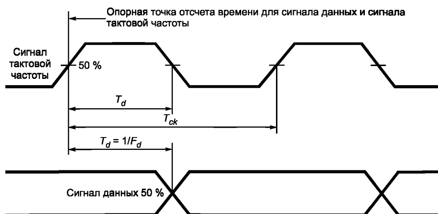
Рисунок 7 — Соотношения параметров синхронизации сигнала и данных
