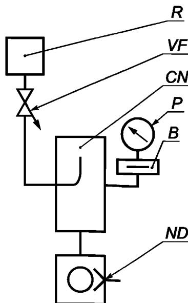
*R — устройство для измерения потока; VF — клапан-натекатель; CN — измерительная камера; P — вакуумметр; B — охлаждаемая ловушка; ND — испытываемый насос*
