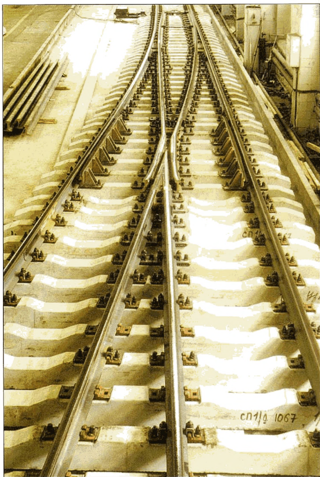
Стрелочный перевод типа Р65 марки 1/9 на ЖББ колеи 1067 проекта ПТКБ ЦП 2845.00.000
