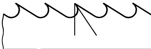
Рисунок 8 — Форма с положительным передним углом
