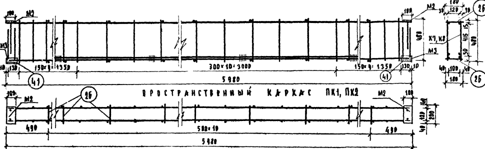
ПЛАН ПРОСТРАНСТВЕННОГО КАРКАСА
