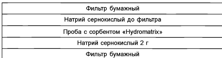
Рисунок 5.3 — Схема заполнения экстракционной ячейки
