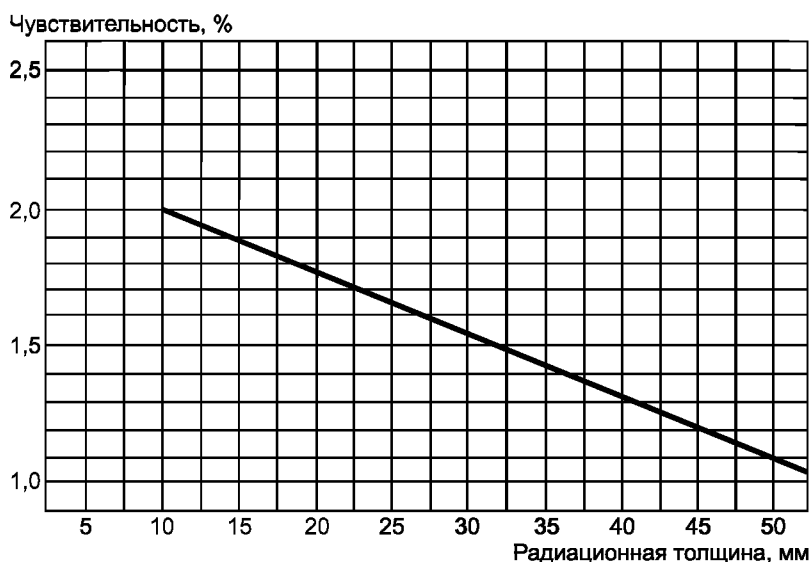
Рисунок D.1 — График чувствительности IQI, %, со стороны источника
