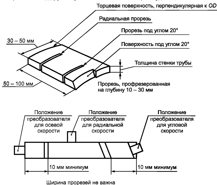
Рисунок G.1 — Испытуемый образец и расположение преобразователей
