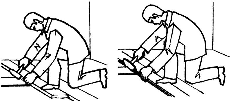
Чтобы при сплачивании не повредить молотком шпунты досок, применяют прокладку из куска шпунтованной доски, которую укладывают гребнем в шпунт паркетной доски и бьют по ней молотком. Сплаченные доски паркетчики прибивают гвоздями в шпунт к каждой лаге. Гвозди они забивают под углом 45°, а затем добойником втапливают шляпки гвоздей в дерево
