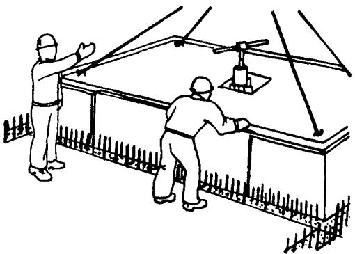
4 ПОДАЧА БЛОКА К МЕСТУ ОЧИСТКИ И СМАЗКИ; 2 мин; Б<sub>1</sub>, Б<sub>2</sub>
