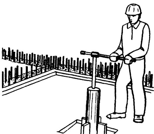
Бетонщик  $B_1$ , находясь внутри блока опалубки, осматривает болтовые соединения и крепления тяг к шарнирам и натяжному винту, при необходимости подтягивая ключом гайки. Бетонщик  $B_2$ , надев удлиняющий патрубок на рукоятку винта механической системы опалубки, по сигналам бетонщика  $B_1$  вращает винт, отрывая опалубку от бетона. Бетонщик  $B_1$  следит за тем, чтобы щиты опалубки свободно перемещались по перекрытию
